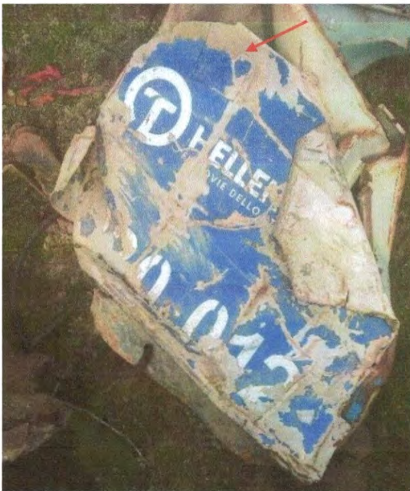
Εικόνα 41: Δείγμα "K3" (Κόκπιτ) από το εμπρόσθιο τμήμα του Θαλάμου Μηχανοδήγησης, με το λογότυπο της εταιρείας και τον αριθμό της Ηλεκτρομηχανής (120 012)
