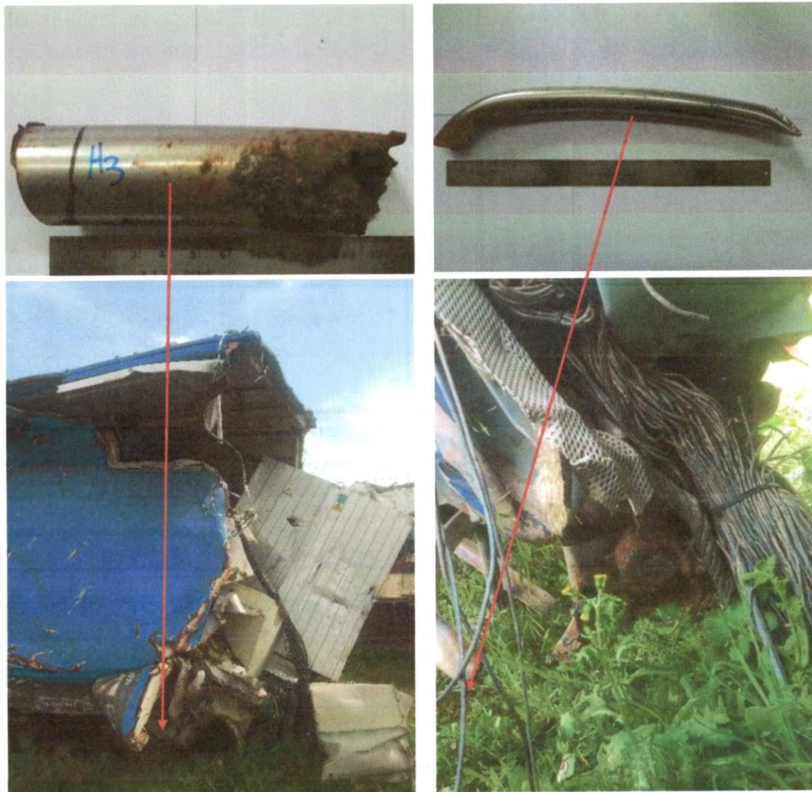
Εικόνα 62: Δείγμα "H3" (Ηλεκτράμαξα 3), από το πίσω και κάτω αριστερά τμήμα της Ηλεκτράμαξας, και αντίστοιχο Δείγμα "K5" (Κόκπιτ 5), τα οποία έχουν αποκοπεί πιθανότατα με οξυακετυλινική κοπή
