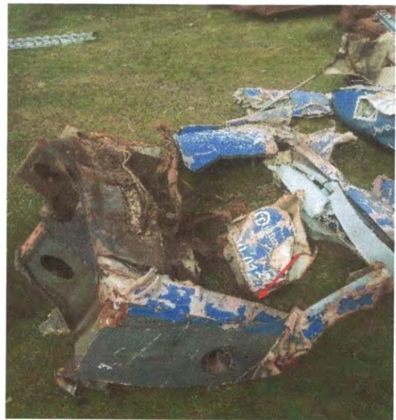
Εικόνα 55: Δείγμα "Κ4" (Κόκπιτ 4) από το πάνω τμήμα της βάσης-προφυλακτήρα του Θαλάμου Μηχανοδήγησης
