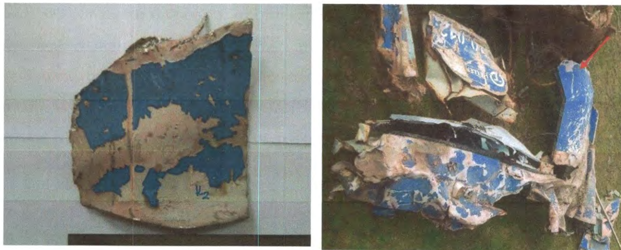
Εικόνα 48: Δείγμα "K2" (Κόκπιτ 2) από το εμπρόσθιο τμήμα του Θαλάμου Μηχανοδήγησης
